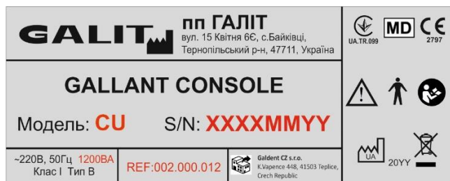
Рис.1.1.1 Ідентифікаційний шильд для стоматологічних установок із верхньою подачею інструментів
